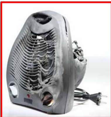
Foto: Heizgerät nach Kurzschluss in Folge Überhitzung (Deutsche Versicherung AG)
